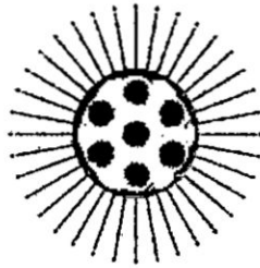
Imagen 3. Distribución del Campo Eléctrico para un Cable Recubierto con Blindaje Semiconductor
