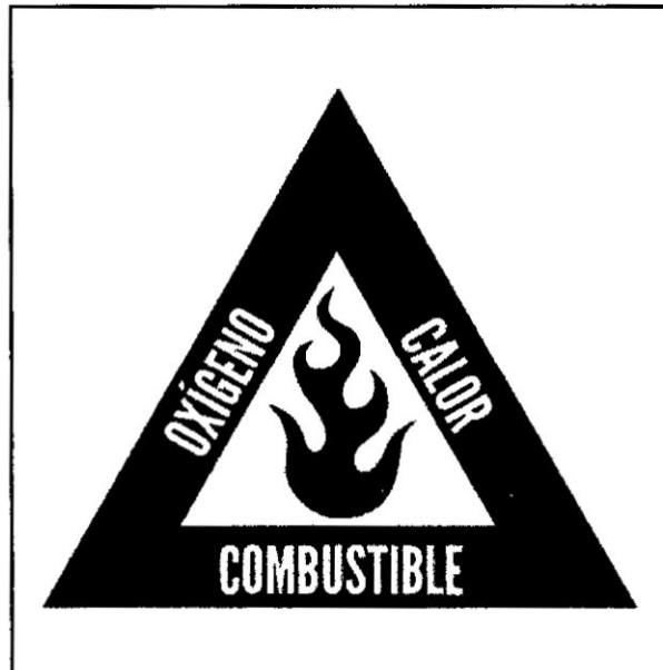
FIGURA 2.10 REPRESENTACIÓN DEL TRIÁNGULO DE FUEGO
