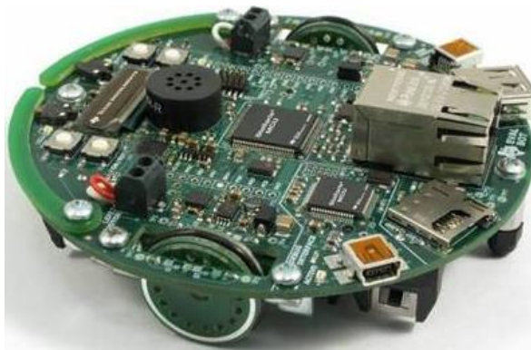
Fig.2.77 Sistema Evalbot con microcontrolador LM3SW9B92 de 32 bits. Fuente: http://www.ti.com/
