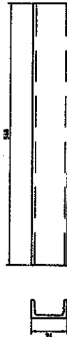
9- BARRILLA PARA BOMBA Material: Acero Estructural ASTM A36 Estructura: Tubo Cuadrado 80mm x 80mm x 4.76mm Cantidad: 02 Escala: 1/3 Tratamiento térmico: No
