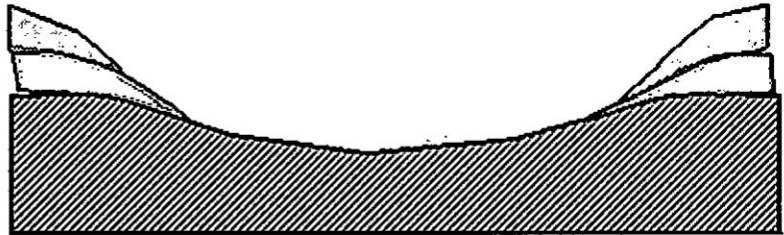
FIGURA N° 18 ÁREA PREPARADA MEDIANTE LIMPIEZA MANUAL / MECÁNICA
