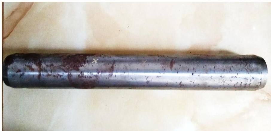
Figura 4.1.1 Pin de marca CTP para Retroexcavadora CAT 420 D
