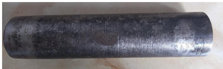
Figura 5.2.1 Cementación líquida de pin de acero SAE 1045
