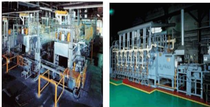
Figura 2.2.15 Horno de paso continuo y horno de cadenas para carburación de acero
