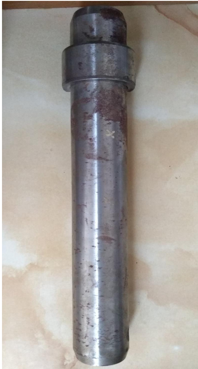
Figura 4.1.3 Referencia de articulación mecánica de pin y bocina, marca CTP, para retroexcavadora CAT 420 D
