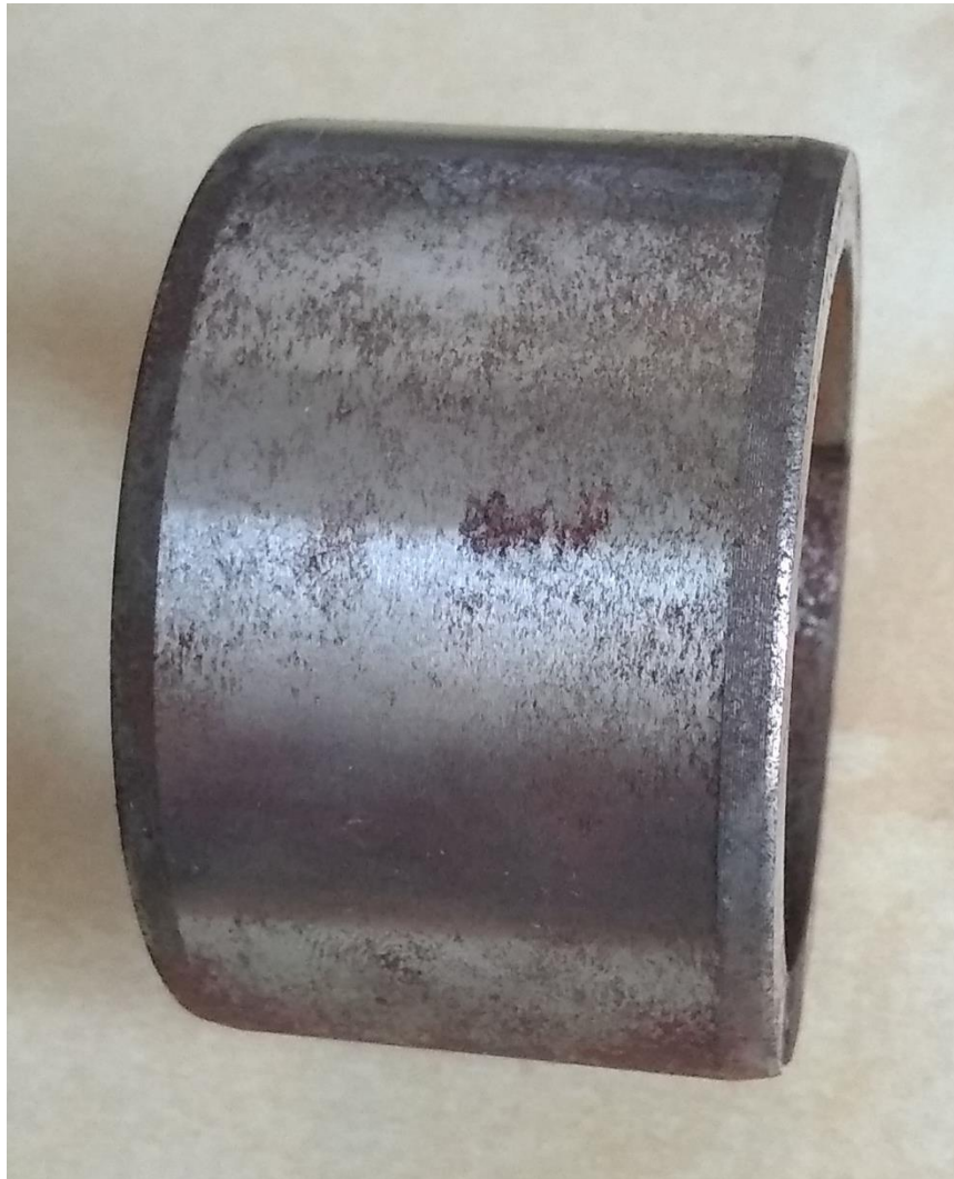
Figura 4.1.2 Bocina de marca CTP para retroexcavadora CAT 420 D
