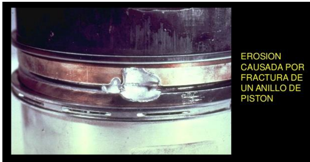
Figura 2.3.16 Desgaste por erosión
