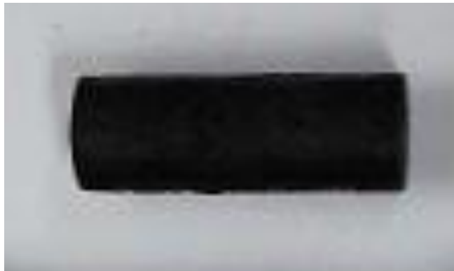
Figura 5.1.1 Probeta de acero SAE 1045 sometida a cementación sólida
