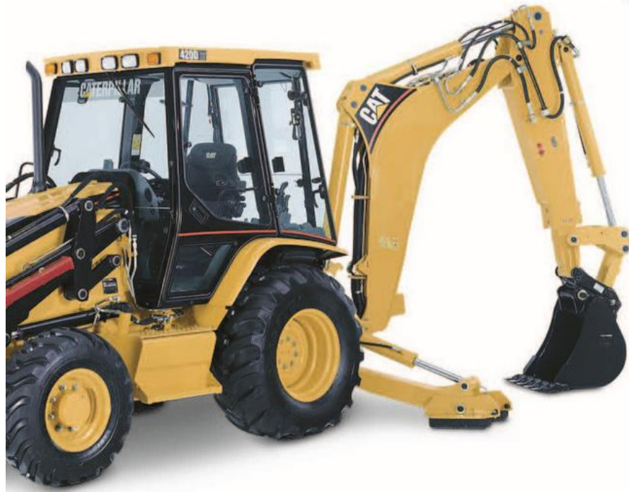
Figura.2.2.26 Posición de excavación de la retroexcavadora CAT 420D
