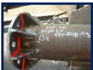
FOTO 3: Se observa los tramos de la Brida 2, Inspeccionado mediante partículas magnéticas vía seca, los cuales no presentan discontinuidades relevantes.
