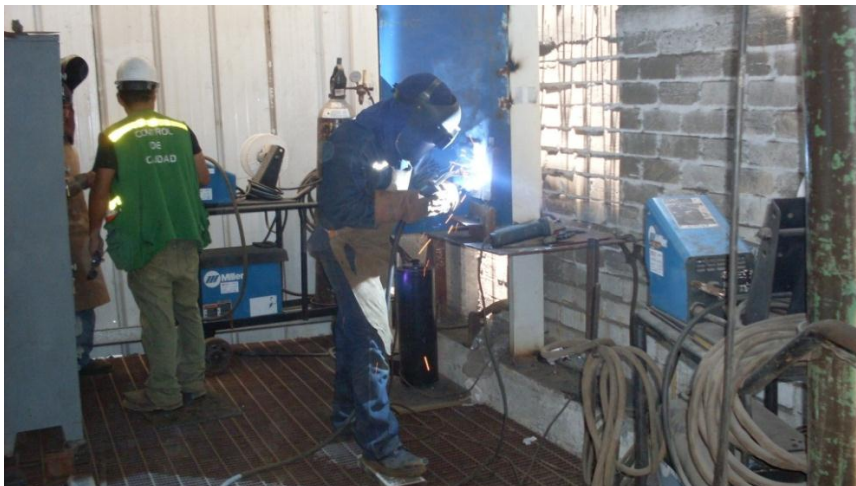
Fig. 4.18 Prueba para calificar soldadores
