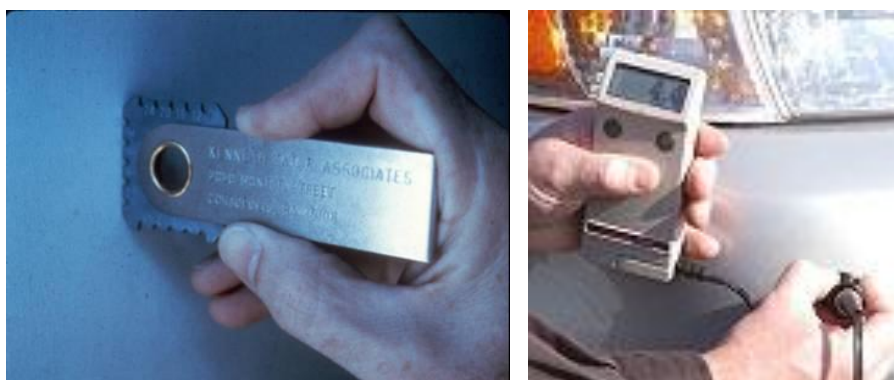
Fig. N° 4.34 Medición de espesor de pintura, en húmedo y seco
