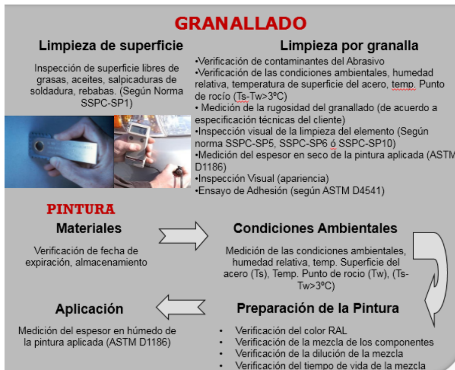
Fig. N° 4.34 Pasos para control de granallado y Pintura
