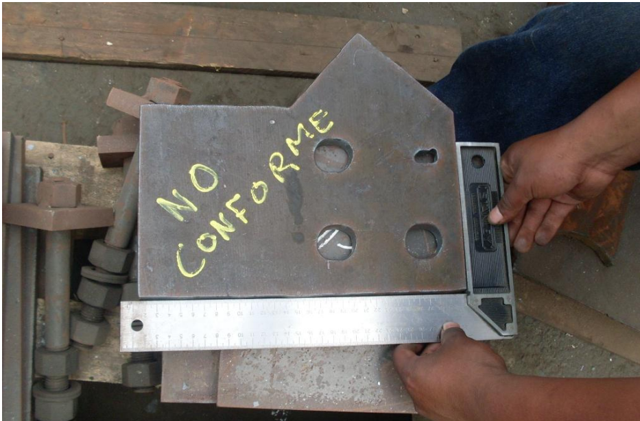
Fig. N° 4.13 Elemento observado por mala perforación
