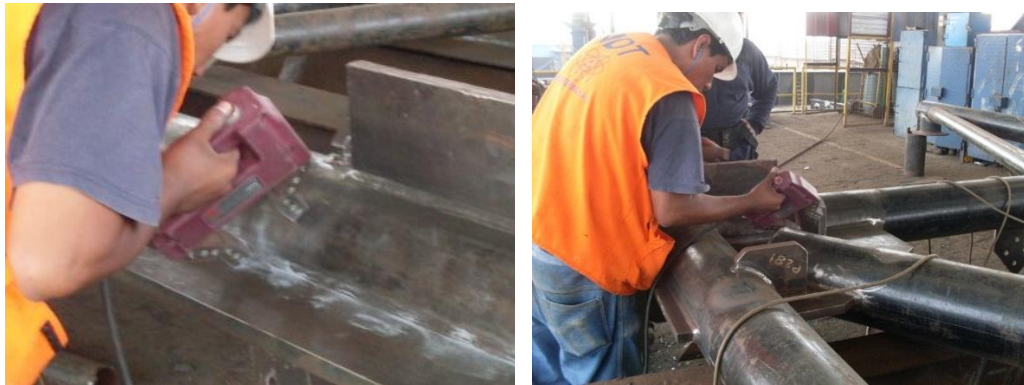
Fig. N° 4.24 realización de ensayo de partículas magnéticas
