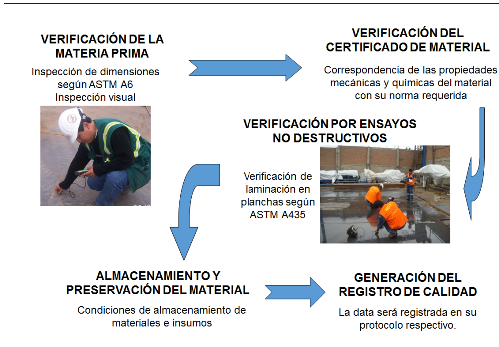
Fig. N°4.4 Inspección de materia prima
