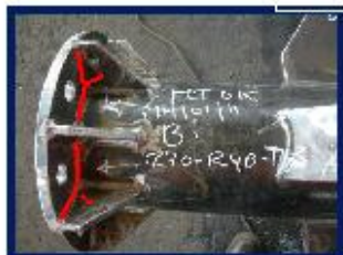
FOTO 1: Se observa los tramos de la Brida 1, Inspeccionado mediante partículas magnéticas vía seca, los cuales no presentan discontinuidades relevantes.
