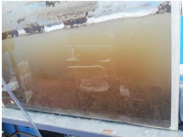
*Figura 46. Reactores con aireación heterogénea*
