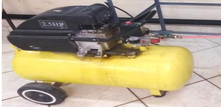
*Figura 34. Compresor de aireación*
