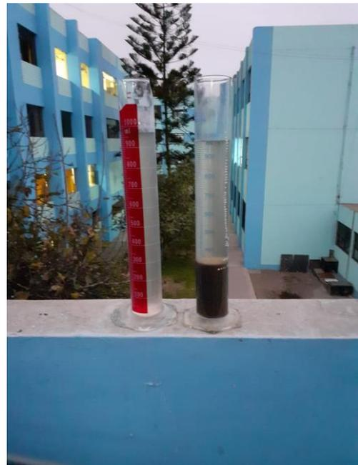
***Figura 55. Sedimentación del reactor y efluente***
