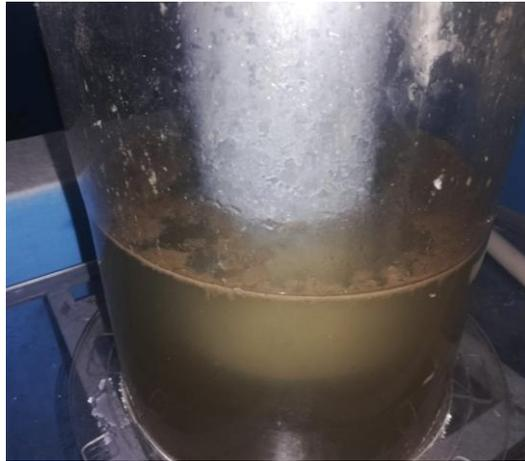
**Figura 48. Efecto bulking presente en el sedimentador**
