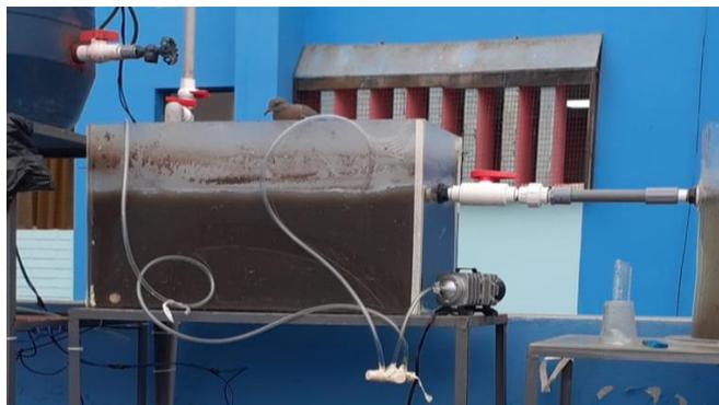
*Figura 63. Reactor lodos activados escala piloto*
