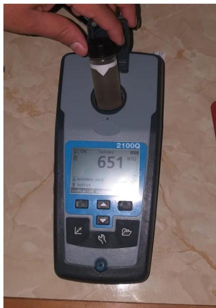
**Figura 18. Turbidímetro HACH modelo 2100 Q**
