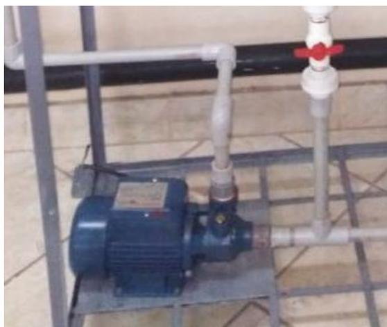
*Figura 33. Bomba de recirculación*
