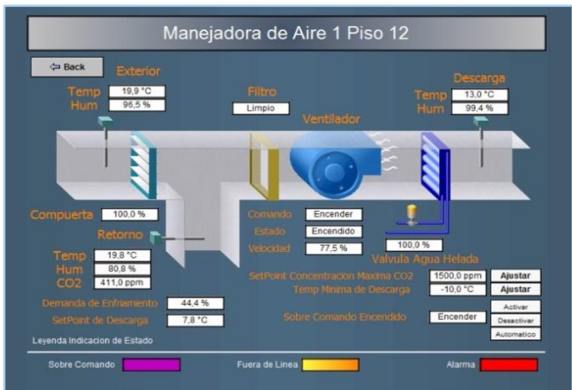
Figura N°2.10 FUNCIONAMIENTO DEL SISTEMA
