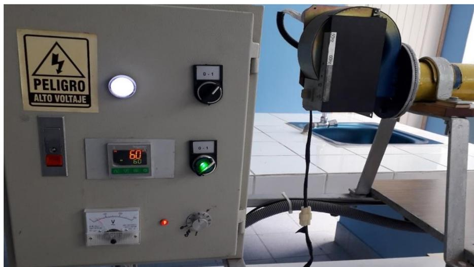
Figura 7. Tablero o consola de control y Ventilador.
