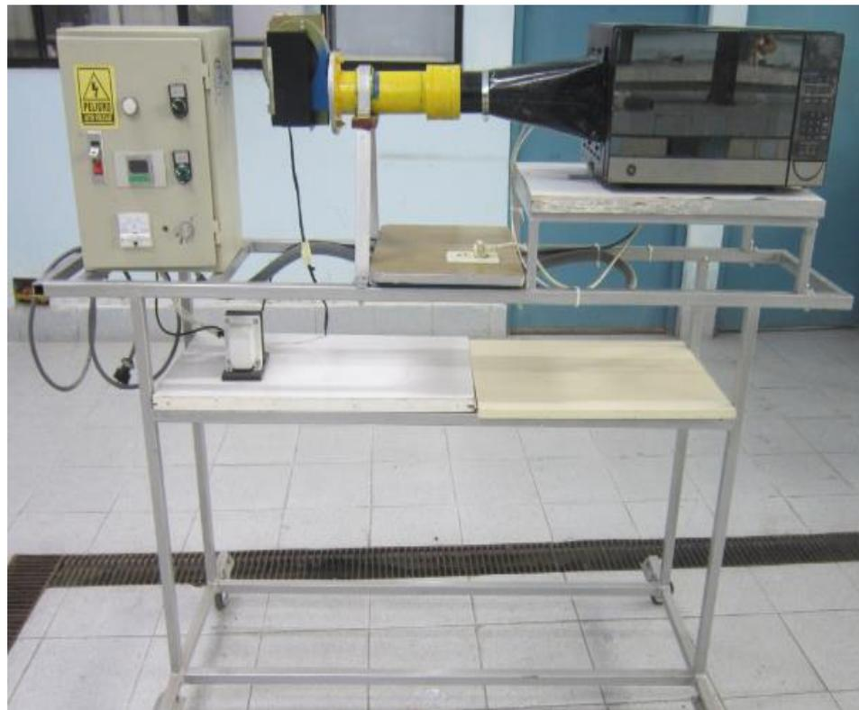
*Figura 6.* Deshidratador experimental que consta de: Consola de encendido y apagado, control de temperatura por medio de una termocupla tipo K, control de velocidad de aire y una cámara con bandeja giratoria para muestras.
