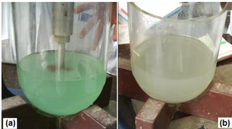
Figura N° 07. Fotografía de cobre lixiviado y agua residual obtenida Fuente: Elaboración propia en laboratorio de operaciones y procesos unitarios de FIQ- UNAC. 2008
