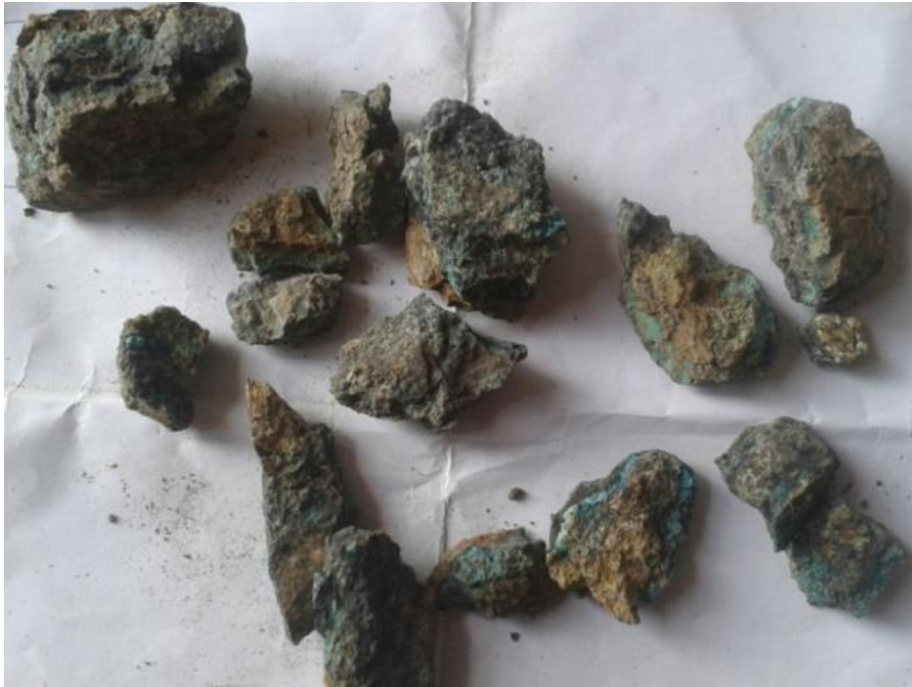
Figura N° 06. Muestra de minerales oxidados de cobre para lixiviar Fuente: Fotografía tomada 2008 por el autor.
