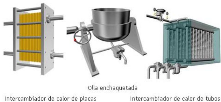
FIGURA N°2.19 APLICACIONES DE CALENTAMIENTO INDIRECTO DE VAPOR
