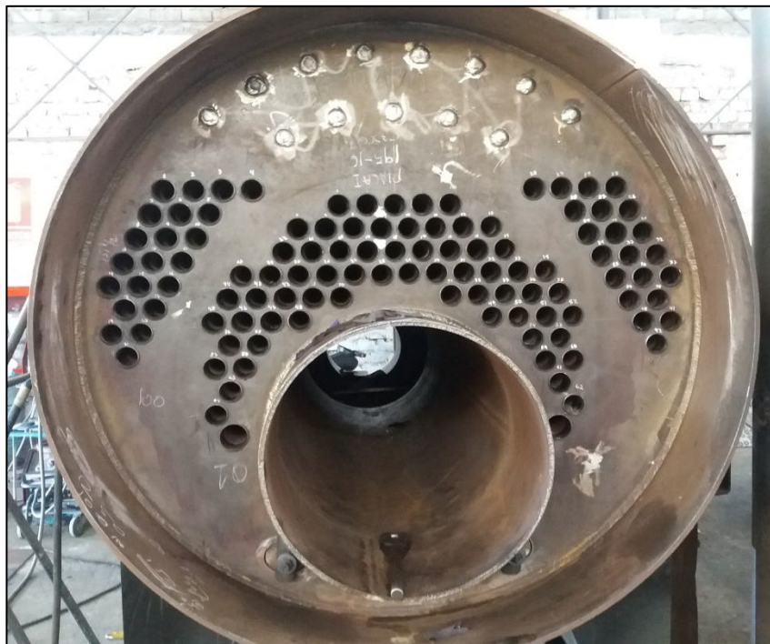
Figura N° 3.26: Fabricación por soldadura - caldera de 120 bhp
