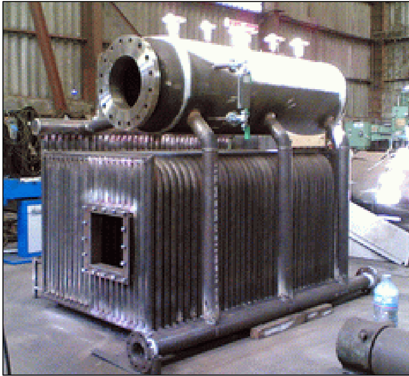
Figura 2.2: Caldera acuotubular en construcción
