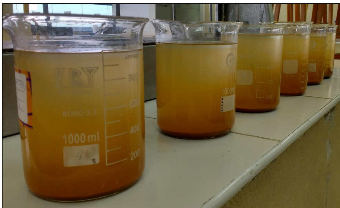
Foto N° 6: Decantación parcial de las diferentes proporciones entre el Efluente Minero y el Agua Residual Doméstica
