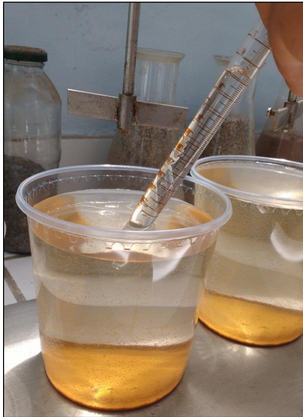
Foto N° 7: Decantación total y extracción del agua tratada para su respectivo análisis
