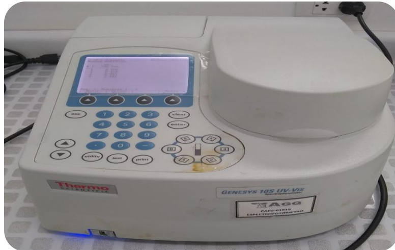
Figura 15. Lectura de muestras por espectrofotometría Elaboración propia
