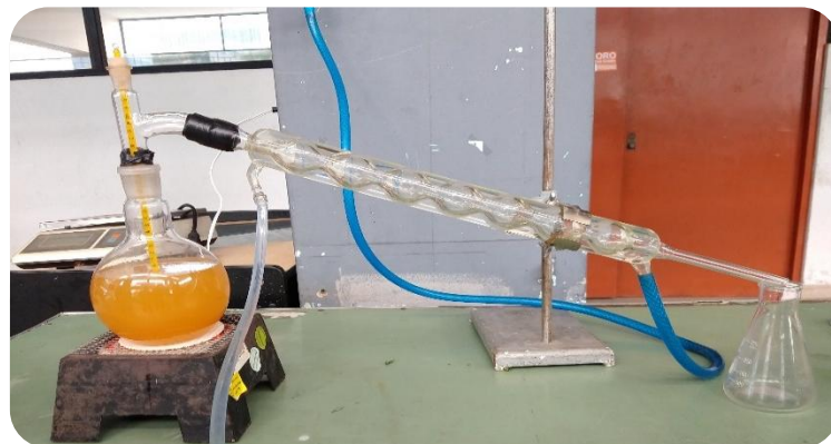
Figura 20. Destilación de la muestra. Elaboración propia
