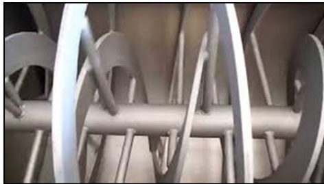
FIGURA N° 07 MEZCLADOR DE CINTAS
