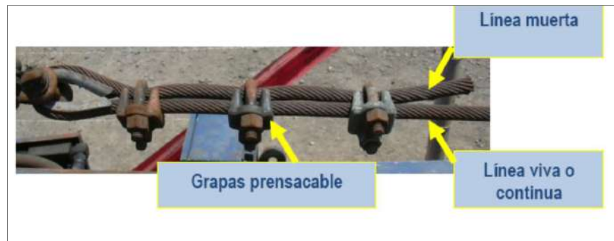
Figura 24 Amarre de cable acerado.
