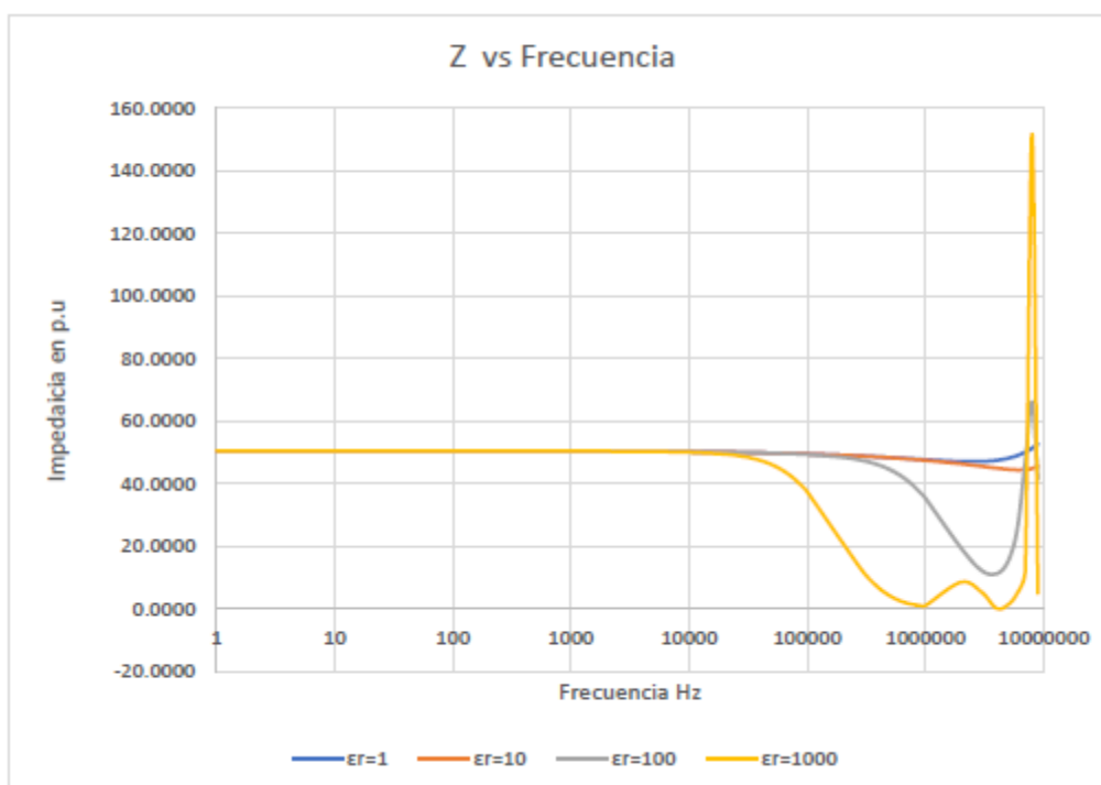
Figura 64. Respuesta del SPAT en función de la frecuencia (Variación de permitividad electrodo horizontal)
