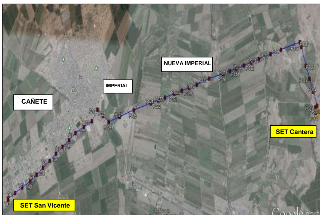
Figura 1: Línea de Transmisión 60 kV SET Cantera – SET San Vicente, L-6610 (Existente).
