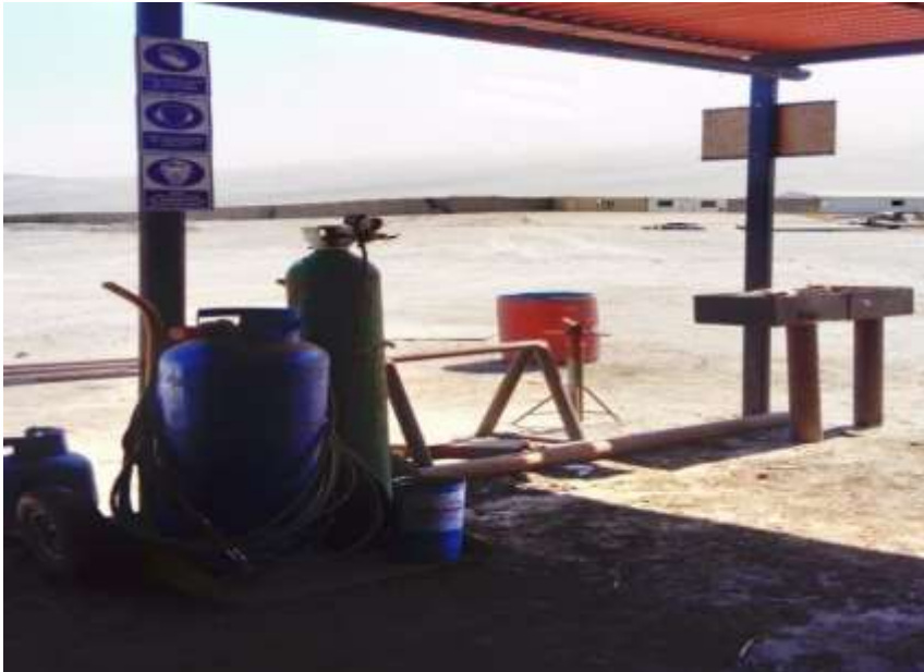
Figura 17: Equipo Oxicorte – Trabajos en caliente.:Portal Koricancha Joint Venture
