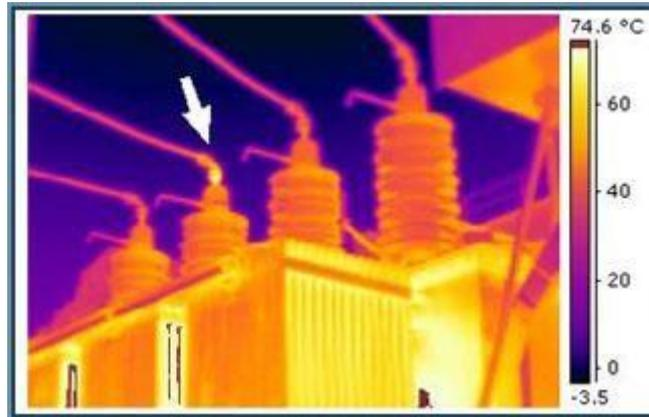
**Figura 32.**Imagen Térmica con Detección de Falla.
