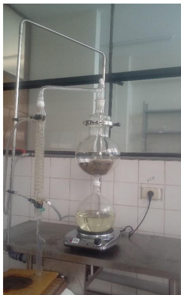
Figura 6. Equipo de destilación. Sistema de arrastre de vapor convencional. Laboratorio de Investigación FIQ. Elaboración Propia.
