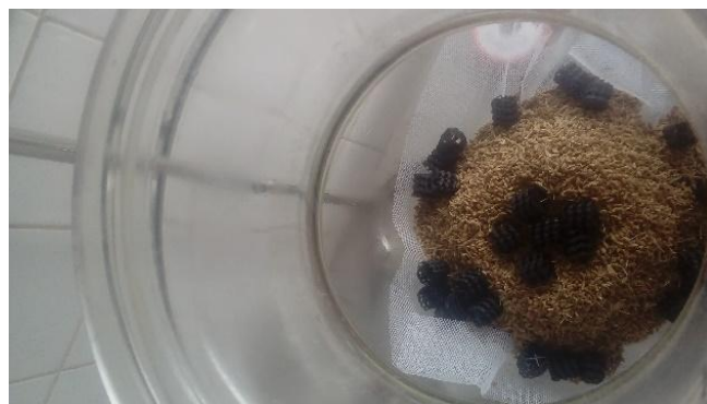
Figura 8. Semilla de anís con material inerte en el sistema de destilación. Laboratorio de Investigación FIQ. Elaboración Propia.
