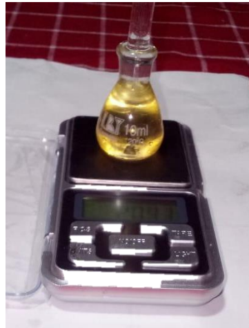
Figura 11. Medición de la densidad. Laboratorio de investigación FIQ. Elaboración propia
