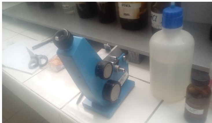
Figura 10. Medición del índice de refracción. Laboratorio de investigación FIQ. Elaboración propia.
