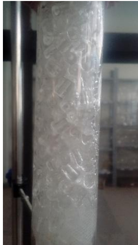
Figura 7. Anillos rashing en la columna. Laboratorio de Investigación FIQ. Elaboración Propia.
