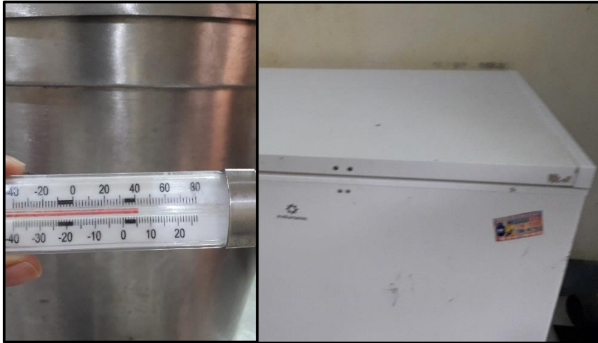
Figura 28. Verificación de la temperatura de la cámara de refrigeración. Fuente propia
