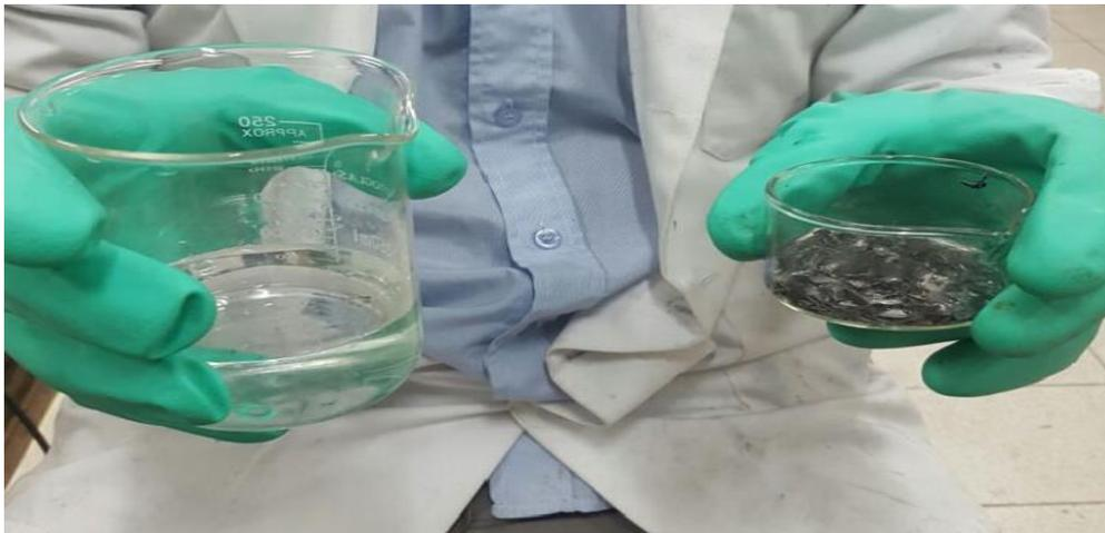
Se dejó que reaccionen los 8 g de chatarra de zinc con el ácido sulfúrico en un vaso de precipitado de 600 ml en una parrilla eléctrica dentro de la campana de extracción.
