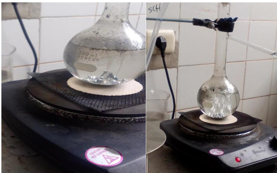
FIGURA N° 4.12 – SOLUCION DE H<sub>2</sub>SO<sub>4</sub> AL 12,5% Y CHATARRA DE ZINC
