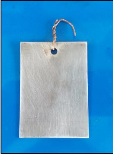
FIGURA N° 4.3 – CÁTODO DE ACERO
