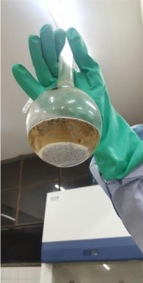
FIGURA N° 4.16 – OBTENCIÓN DE SULFATO DE ZINC
