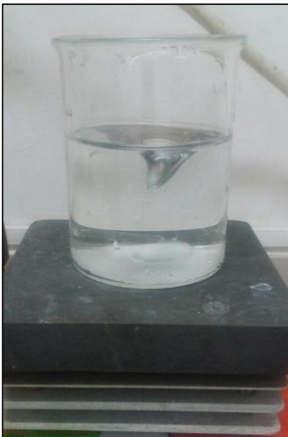
FIGURA N° 4.5 – AGITADOR MAGNÉTICO
