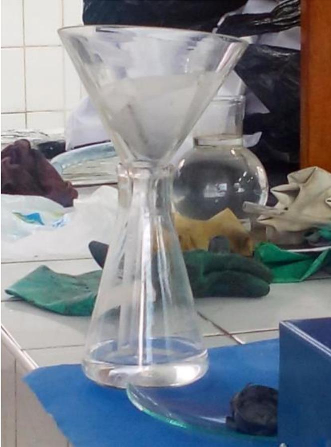
FIGURA N° 4.14 – FILTRADO DE LA SOLUCIÓN
