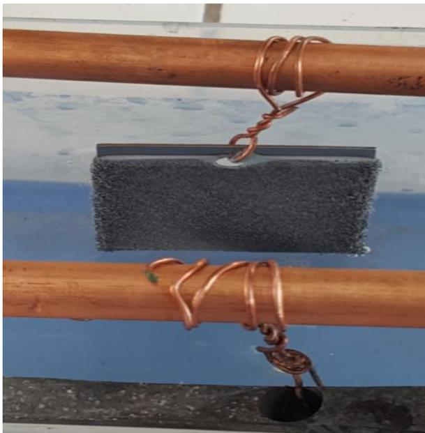
La transformación del ion  $Zn^{+2}$  en zinc metálico se dio en la solución mientras el rectificador siguió encendido durante 10 a 20 minutos. Se retiró el cátodo.
