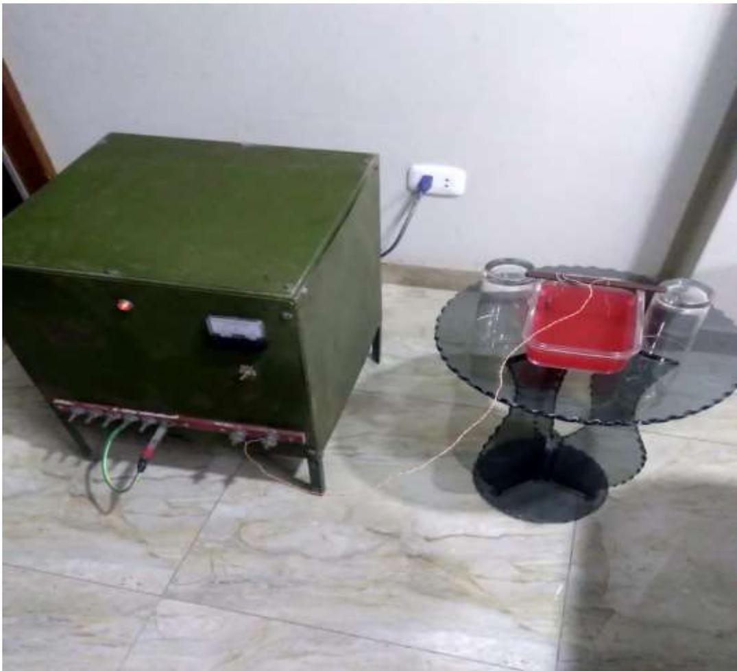
*Nota:* Aquí la misma muestra se somete a observar la degradación de color, empleando ánodos diferentes y variando el tiempo.
