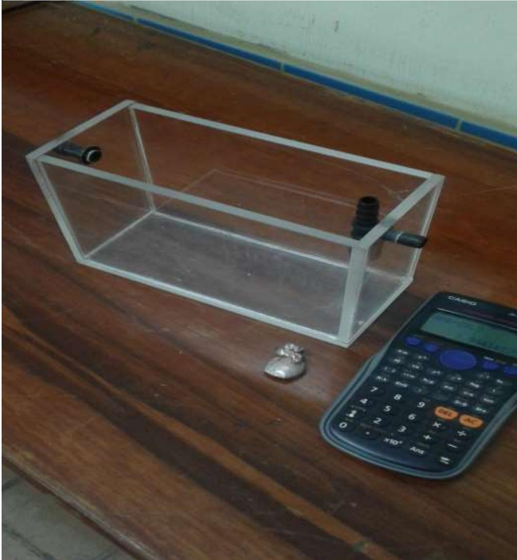
Son los receptáculos que sirven para depositar el electrolito, que en nuestro caso está constituido por las muestras de aguas coloreadas de impresión gráfica. Estas deben ser de un material adecuado, en nuestro caso son de acrílico a fin no contaminar con otros elementos.
