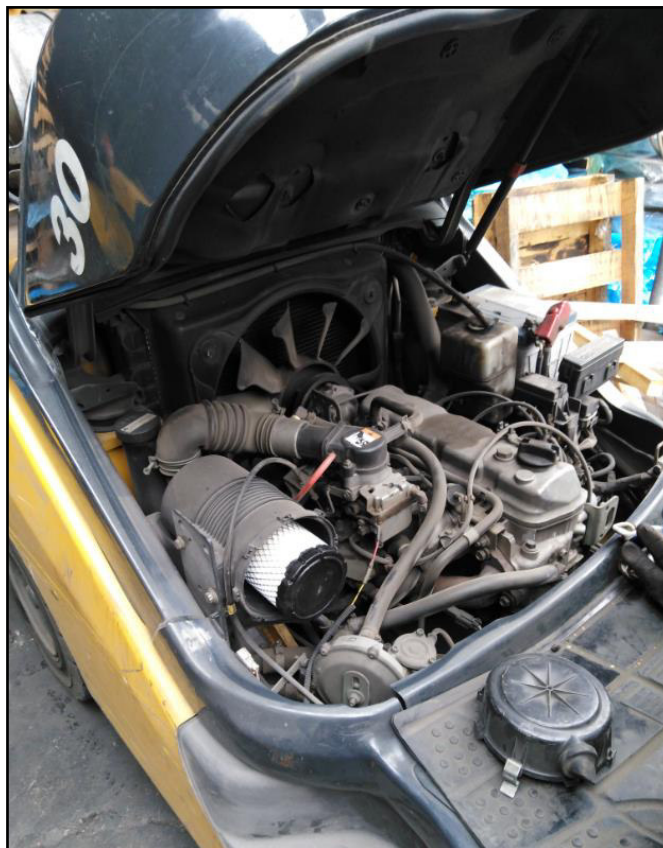
FIGURA 5.23 ENSAMBLE EN MOTOR DE PROTOTIPO FABRICADO CON MOLDES EN 3D DE FILTRO DE AIRE CON SELLO RADIAL 01
