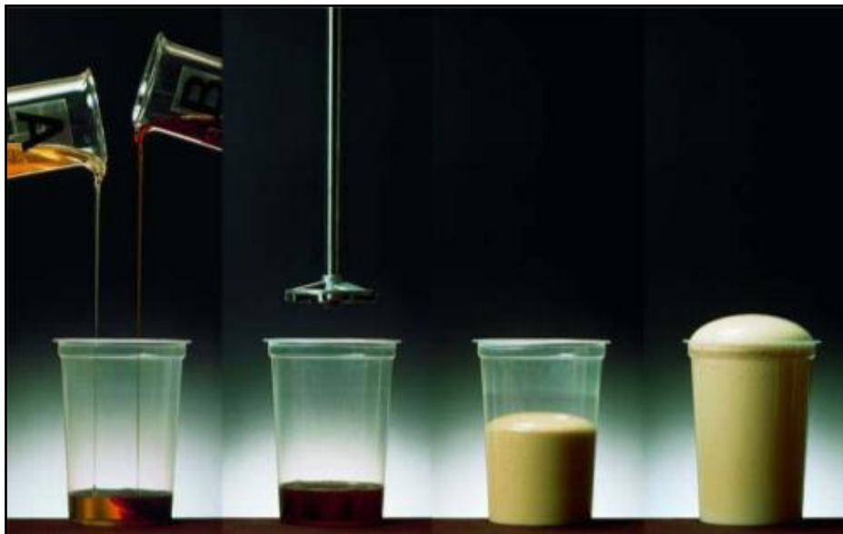
FIGURA 2.11 PROCESO DE ESPUMACIÓN DEL POLIURETANO
