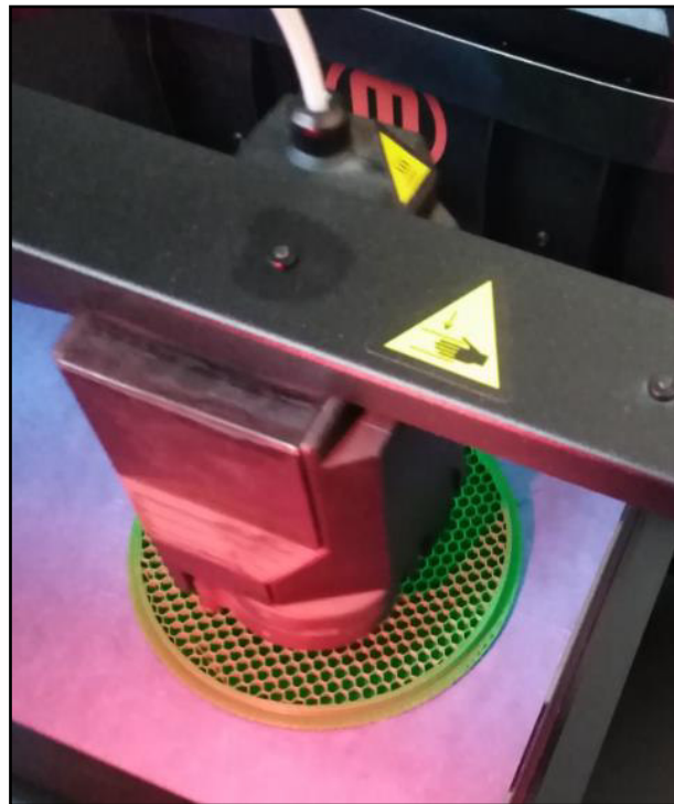
FIGURA 5.2 IMPRESIÓN DE LOS MOLDES CON RELLENO HEXAGONAL
