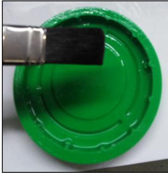
FIGURA 5.4 PRIMERA CAPA DE RESINA EPOXI A MOLDE MHA01 3D
