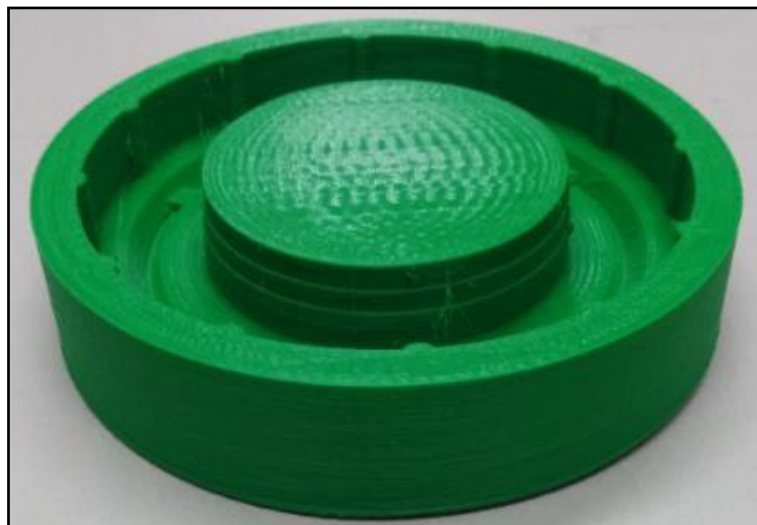
FIGURA 5.3 MOLDE MHA01 3D SIN ACABADO SUPERFICIAL
