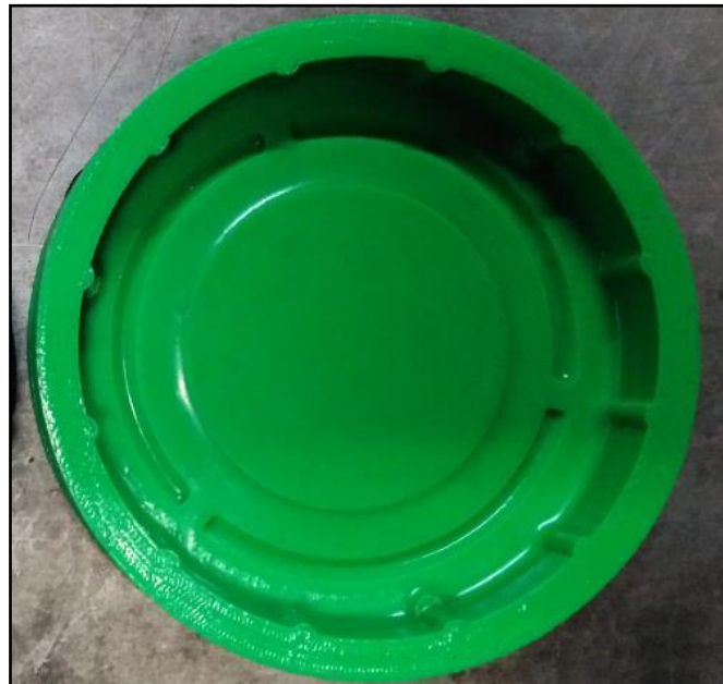
FIGURA 5.6 MOLDE MCA01 3D CON DOS CAPAS DE RESINA EPOXI
