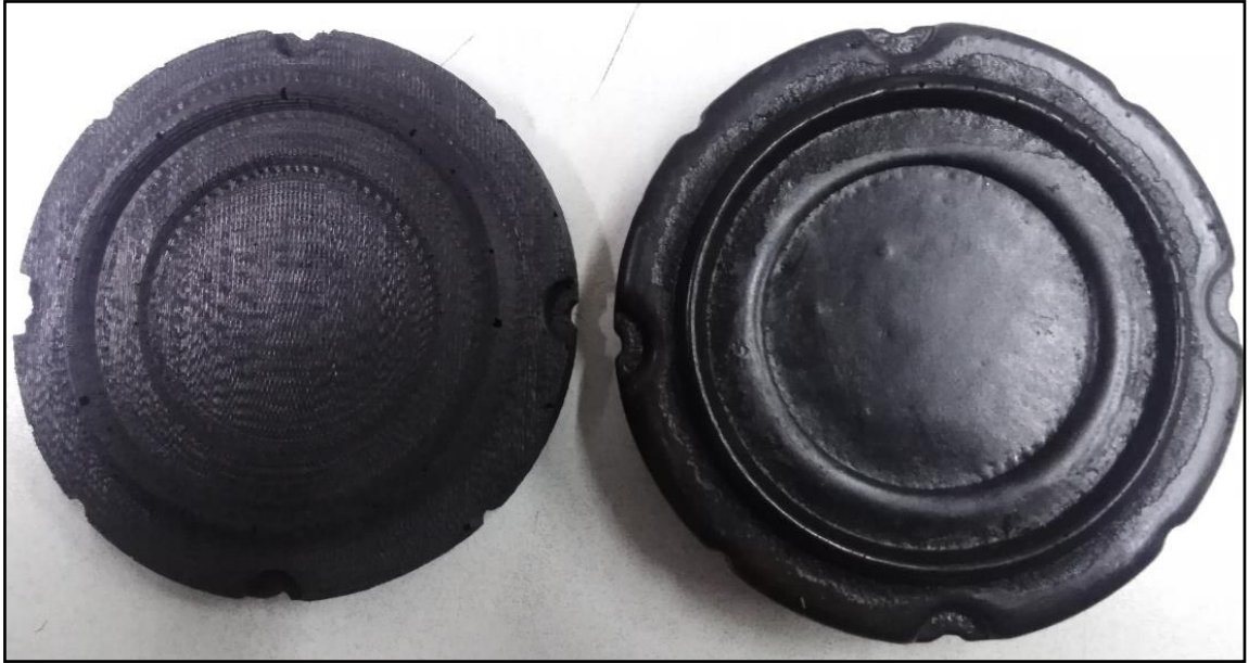
FIGURA 5.16 POLIURETANO DESMOLDADO DEL MOLDE MCA02 3D SIN CAPA DE RESINA EPOXI Y CON DOS CAPAS DE RESINA EPOXI
