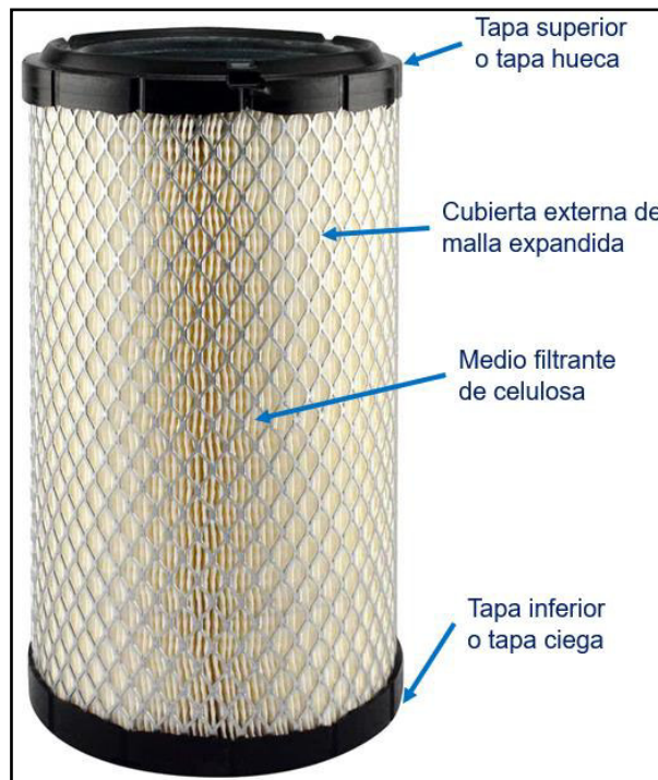
FIGURA 2.10 PARTES DE UN FILTRO DE AIRE CON SELLO RADIAL
