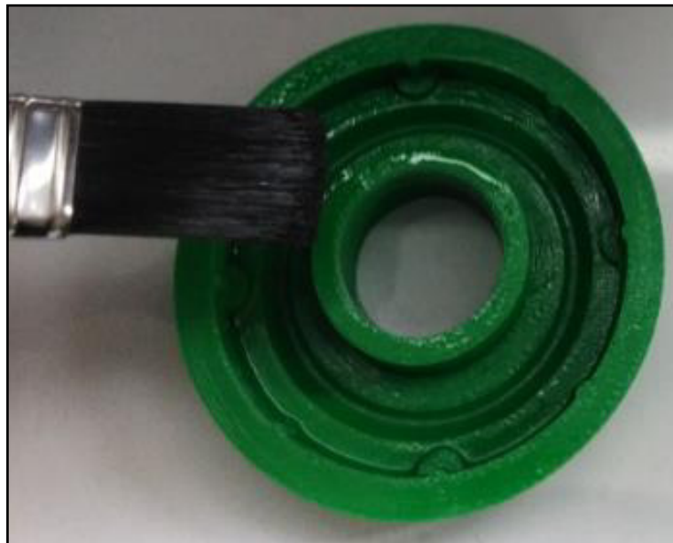
FIGURA 5.8 PRIMERA CAPA DE RESINA EPOXI A MOLDE MCA02 3D
