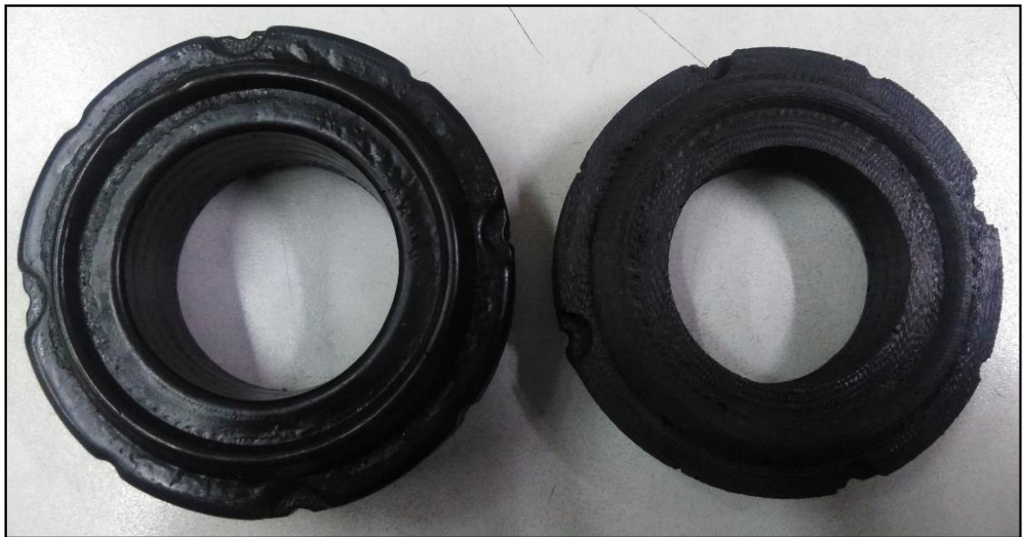
FIGURA 5.17 POLIURETANO DESMOLDADO DEL MOLDE MHA02 3D SIN CAPAS DE RESINA EPOXI Y CON DOS CAPAS DE RESINA EPOXI
