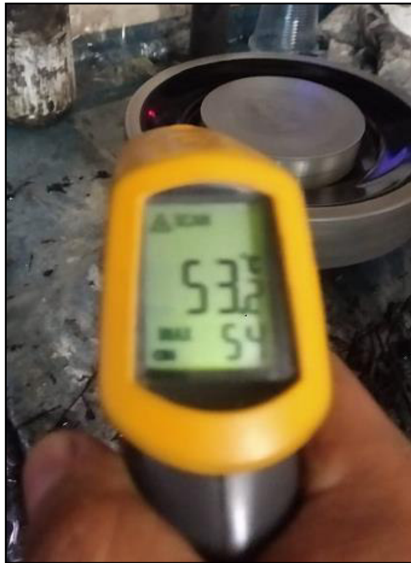
FIGURA 5.1 MEDICIÓN DE LA TEMPERATURA MÁXIMA DEL POLIURETANO
