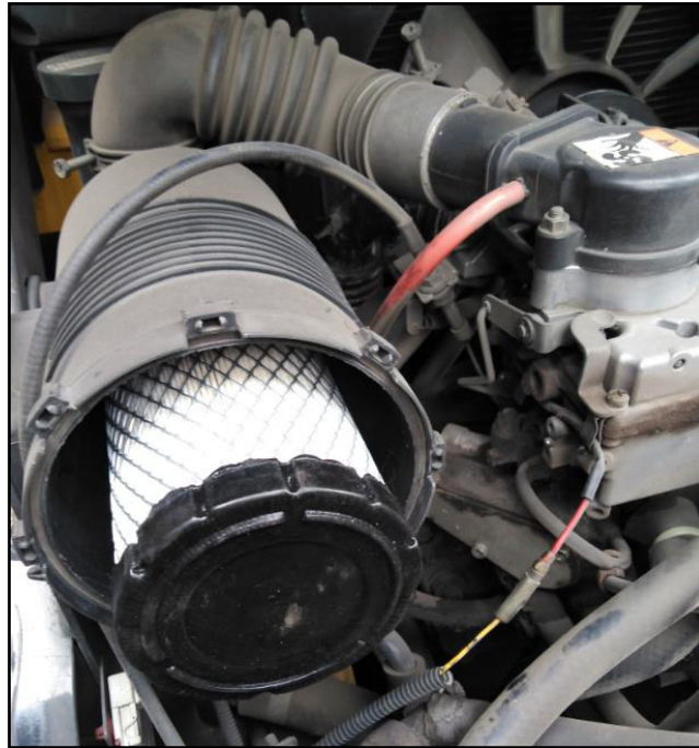
FIGURA 5.22 CORRECTO ENSAMBLE DE PROTOTIPO FABRICADO CON MOLDES EN 3D DE FILTRO DE AIRE CON SELLO RADIAL 01
