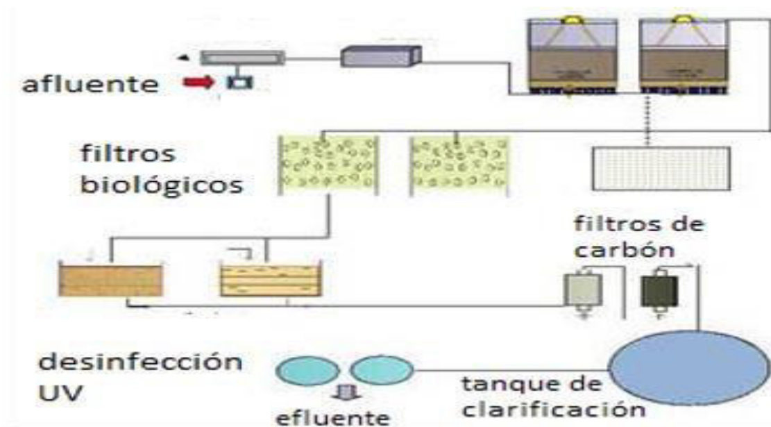
Fig. N°4: Sistema de Tratamiento de Agua Textil
