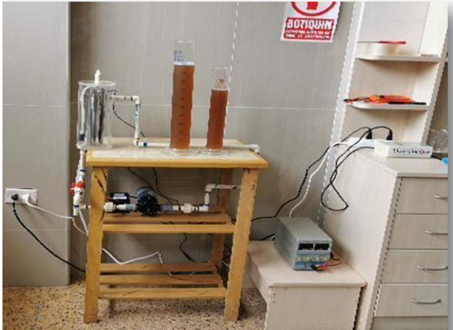
En la figura 5 se muestra la celda de electrocoagulación en pleno proceso de una corrida experimental.
