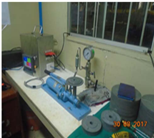
Figura N° 2.47. Balanza de peso muerto y Registrador de presión y temperatura
