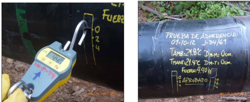
Figura N° 2.46. Prueba de adherencia
