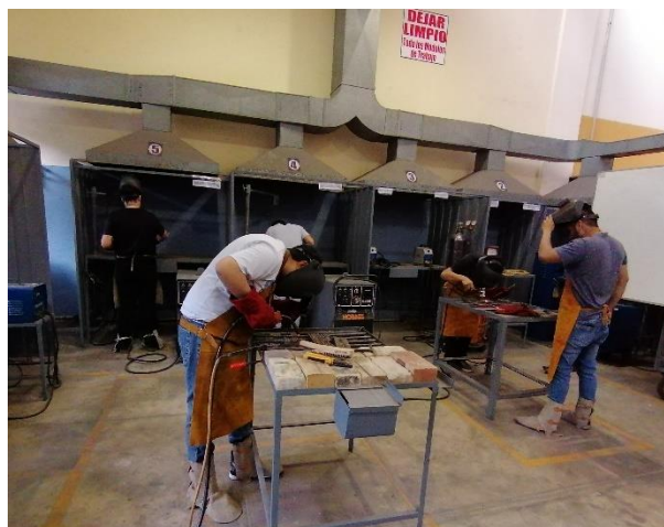
Figura N° 5.17 Protección de los alumnos en el Taller de Soldadura y Ensayos No Destructivos
