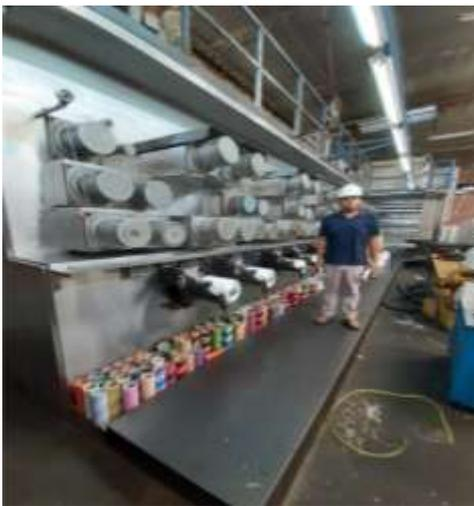
*Foto 3.* Maquinaria de enrollado en conos Control de Calidad
