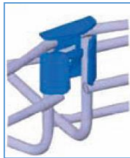
Características de accesorio en curva de bandeja metálica.
