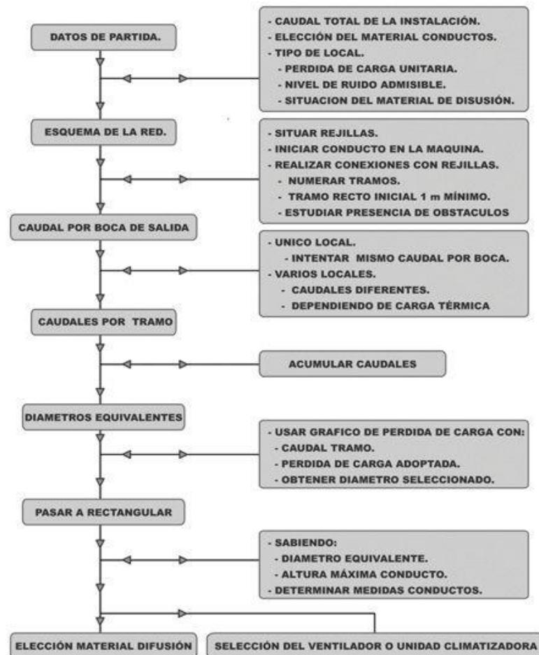
Diagrama de flujo para el diseño de ductos de ventilación
