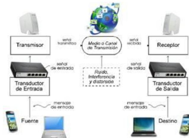
Figura 2.2 Componentes de un sistema de telecomunicaciones
