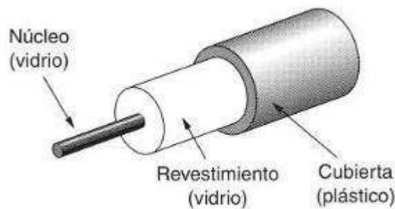
Figura 2.3 Partes de una fibra óptica
