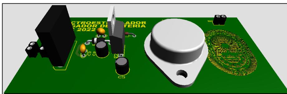
Figura 25. Modelo 3D del cargador de baterías (Vista angular superior)
