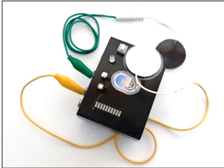
Figura 32. Modelo de electroestimulador Kotz con dos electrodos
