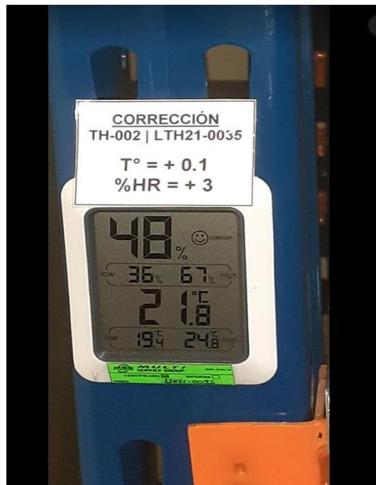
Figura N° 15: Se colocaron los termohigrómetros para la medición de temperatura y humedad en el almacén.
