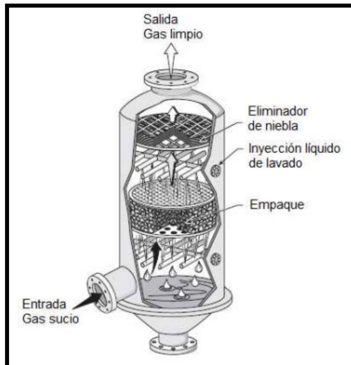
Figura 2.11: Lavador de gases tipo torres empacadas.
