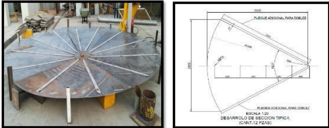
Figura 16. Fabricación de base cónica de EFH
