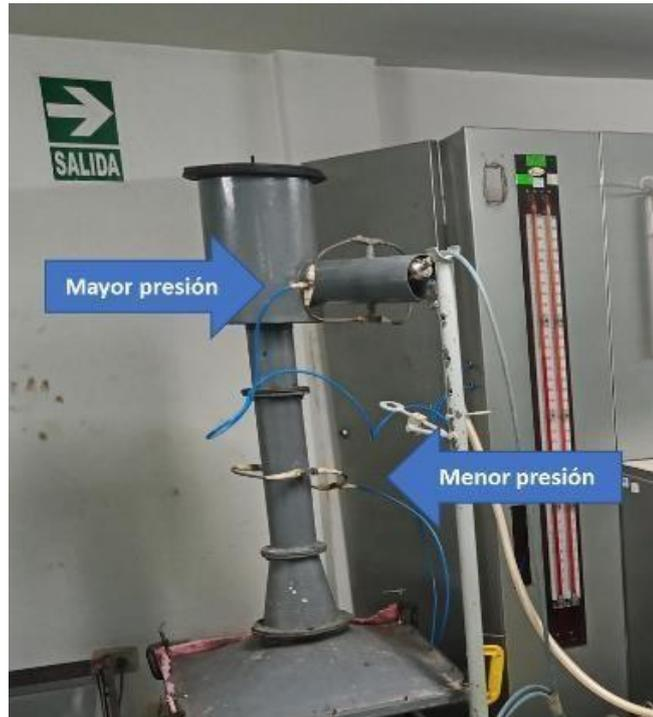
**Imagen 4.2.** Carcasa porta-filtro para ensayos de performance
