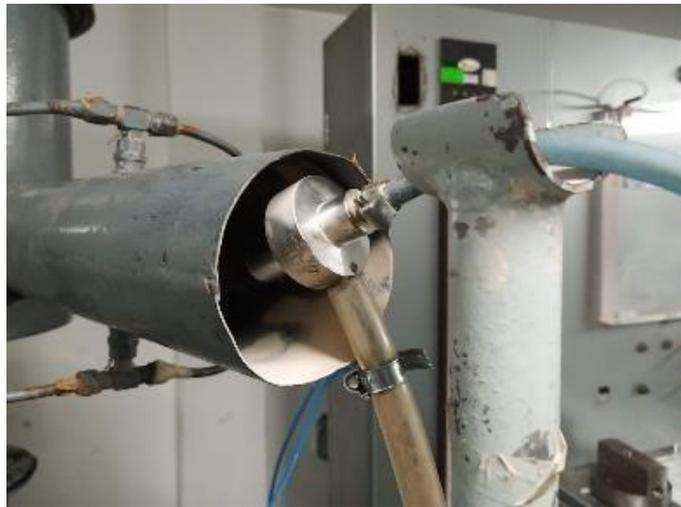
Comenzamos con la alimentación del polvo contaminante bajo las condiciones de operación del flujo nominal ( $4\text{m}^3/\text{min}$ ) y caída de presión inicial (KPa) determinadas en el ensayo de resistencia al flujo de aire para cada filtro estándar de prueba. Registramos la masa del contaminante dosificado en la
