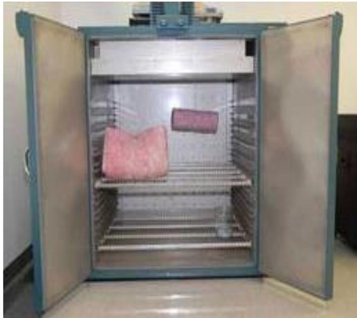
Una vez secado el filtro absoluto, hay que secar también el polvo contaminante ISO 12103-1 A2 Fine en la cantidad requerida para el ensayo, a las mismas condiciones de secado del filtro absoluto. Es importante que este polvo ISO no presente humedad provocado por las condiciones de la calidad del aire interior en el laboratorio.
