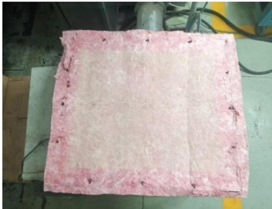
**Imagen 4.15.** Filtro muestra estándar en condiciones finales de ensayo
