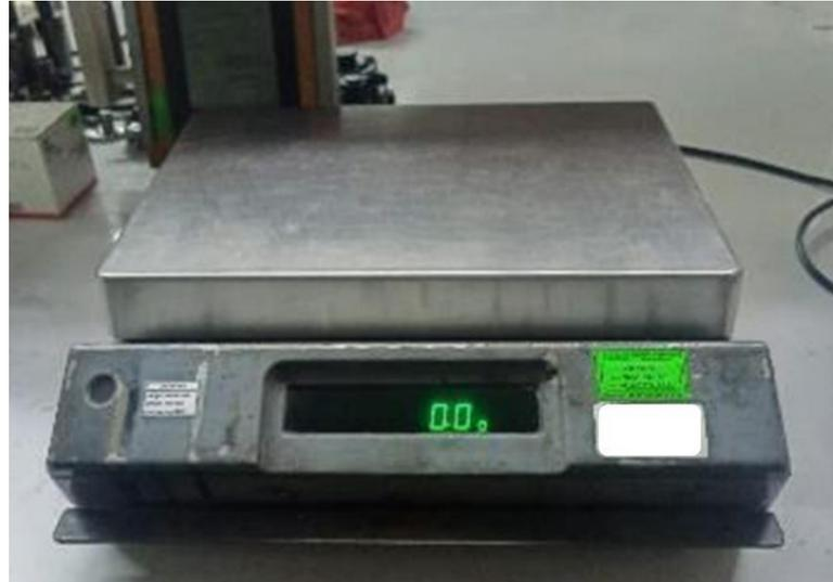
Registramos en la misma balanza que se muestra en la imagen 4.7, el peso inicial de la carcasa vacía sin la tapa y del filtro de aire a probar con una aproximación de 0,1gr.
