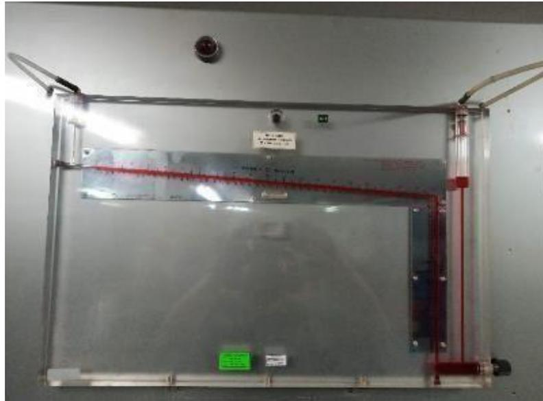
Después, se debe llevar el flujo de aire hasta su valor nominal calculado anteriormente, haciendo uso del diagrama del medidor de flujo por efecto Venturi, ver anexo 8. Durante un tiempo de 3 minutos, verificamos que se mantenga el diferencial de presión al observar el manómetro de columna líquida inclinada.
