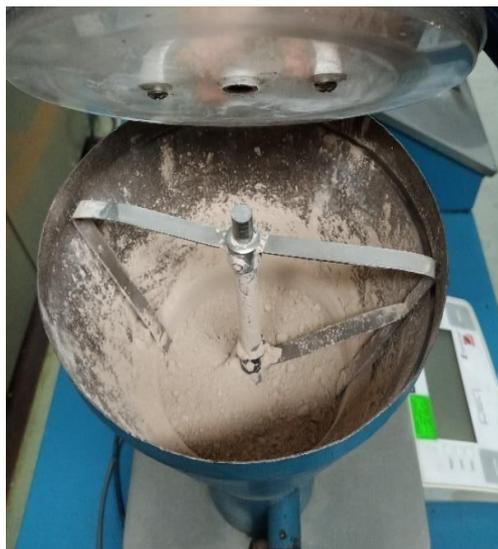
Luego de apagar el banco, retiramos cuidadosamente de la carcasa cada filtro muestra ensayado, para registrar su peso final por separado en la balanza electrónica de 15Kg. De igual manera, proceder con el filtro absoluto al desmontarlo de su carcasa, tal como se muestra en la imagen 4.14.
