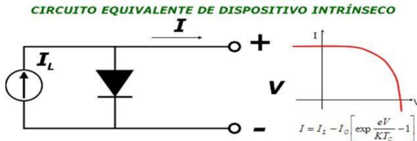
FIGURA N°18. Circuito equivalente de dispositivo intrínseco
