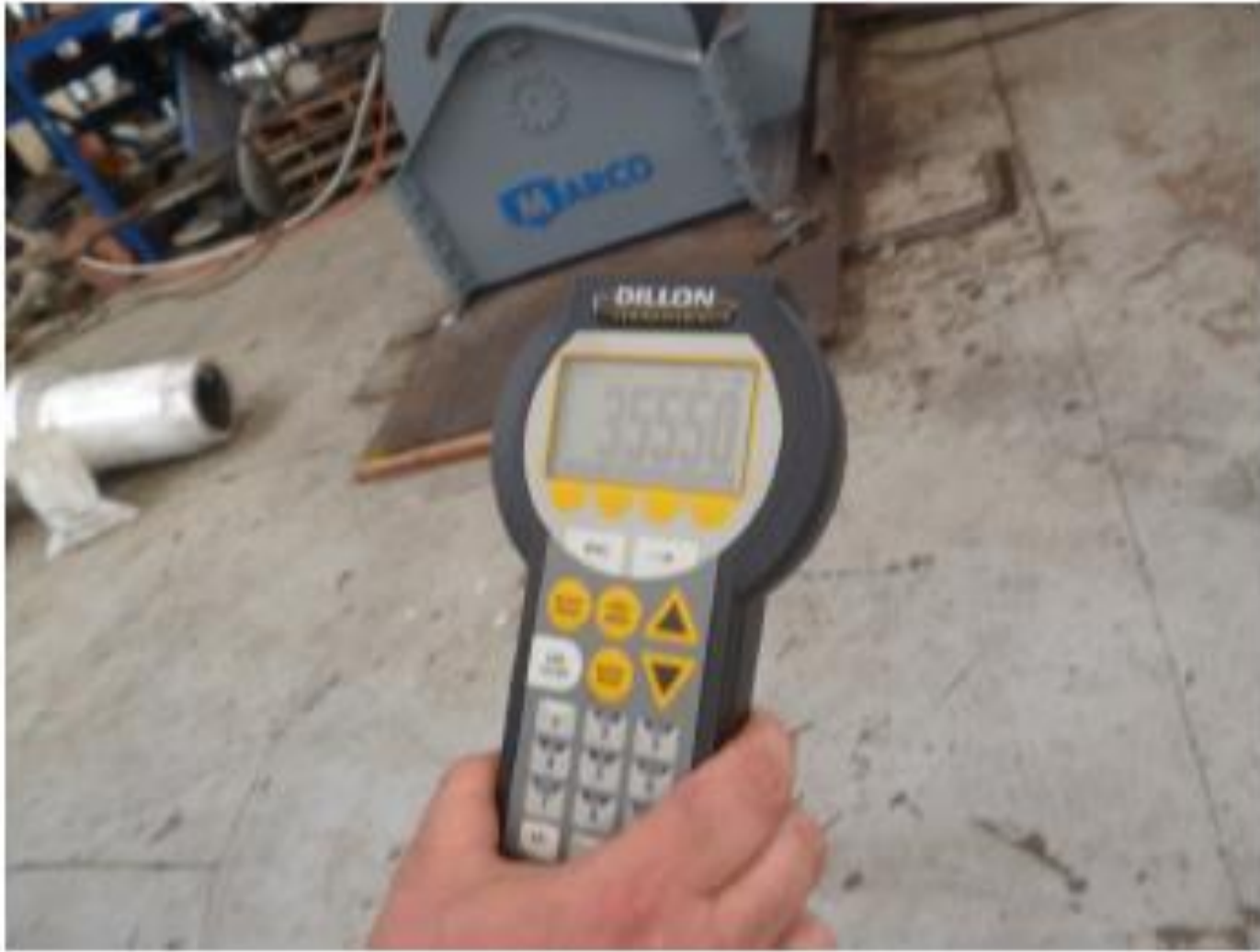
Fig. 1: Lectura de dinamómetro en la prueba de tiro.
