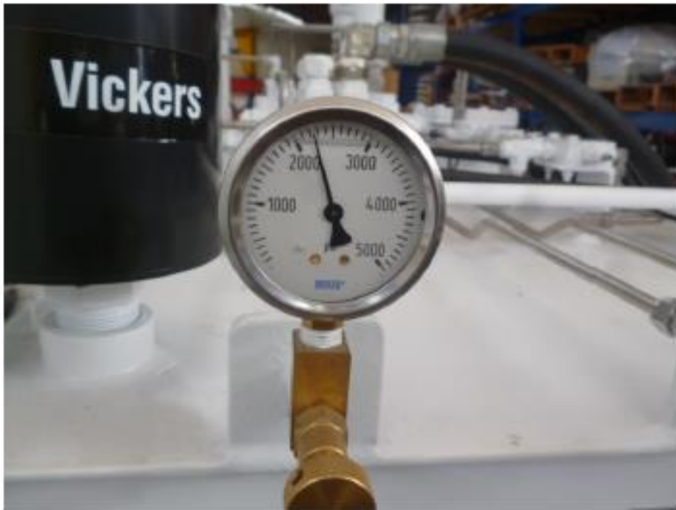
Fig. 3: Lectura de la presión del fluido alcanzado en la prueba de tiro
