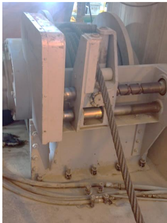
Figura 4. 44. Anclaje de Cabrestante. Tomado de “Elaboración propia”
