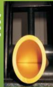
Comportamiento de la tubería finalizada la prueba
