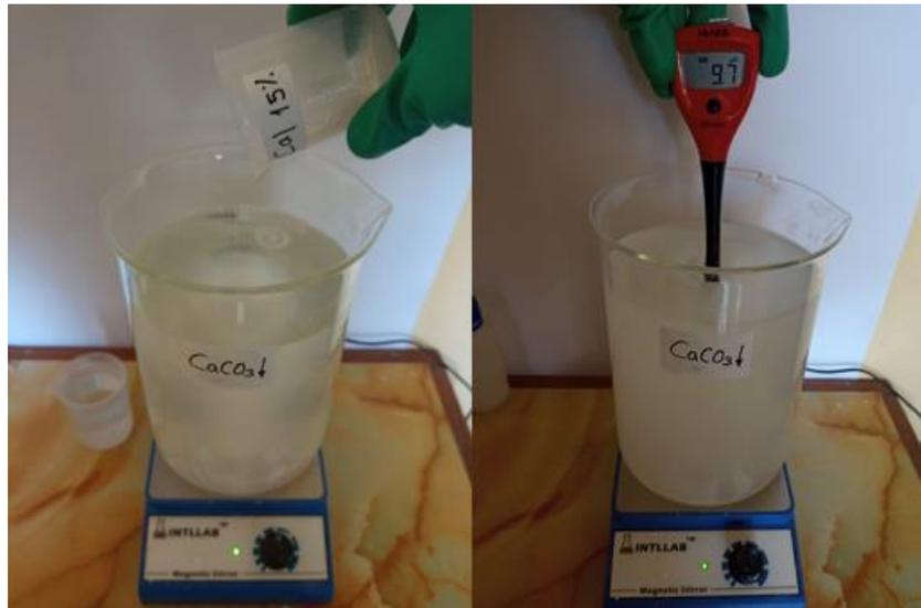
En la figura 10 se muestra el carbonato de calcio precipitado
