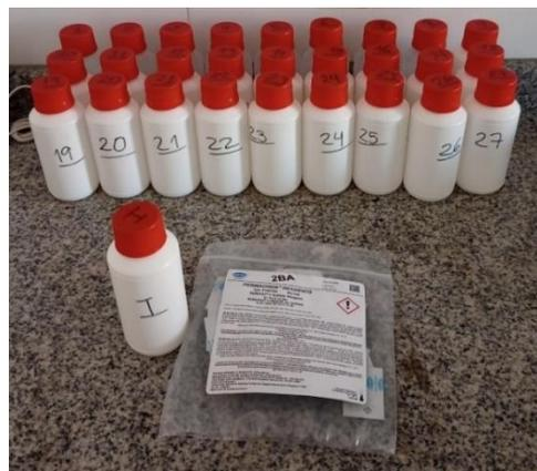
Se realizó la medida de sulfatos del agua tratada, para lo cual se realizó dilución previa en razón de 1/25 ya que el rango de medición es 2 – 70 ppm. El resultado obtenido se debe multiplicar por 25 para obtener la cantidad de sulfatos total. En la figura 15 se observa la medición de una de las muestras de agua tratada.
