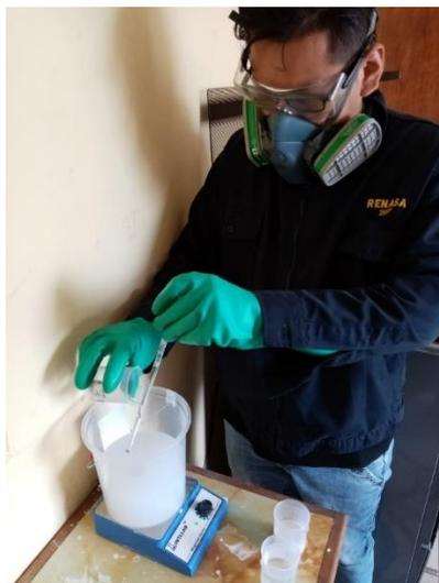
Se realizó el control de pH para la precipitación de etringita, tal como se muestra en la figura 13.
