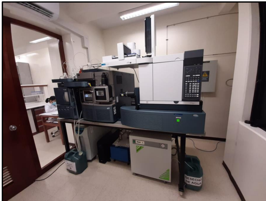
Foto del equipo Cromatografo Líquido acoplado a Espectrometría de Masas Triple Cuadrupolo del CITEacuícola de la UPCH
