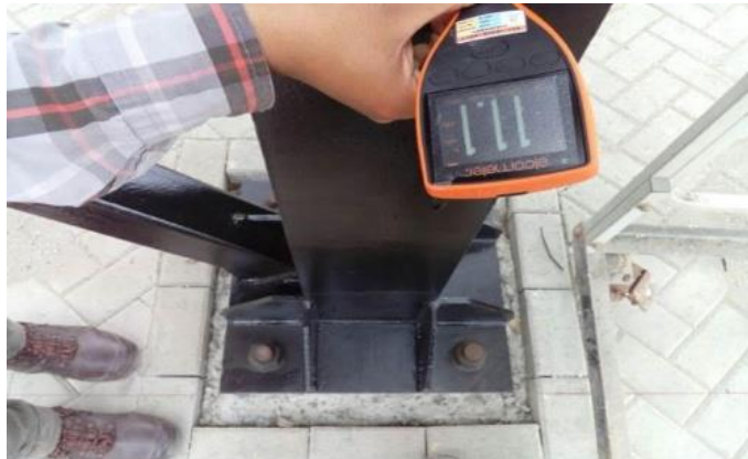
Imagen 32: Liberación de espesor de pintura seca
