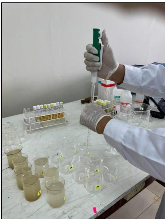
**Foto 9.** Rotulación de viales para medición de DQO
