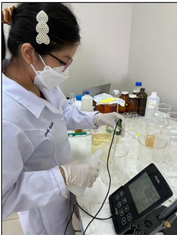
**Foto 8.** Adición del ácido sulfuro en las muestras del agua residual, para poder medir la DQO.
