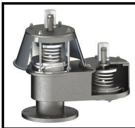
Figura 17 Válvula de Presión-Vacío accionada por Resorte.
