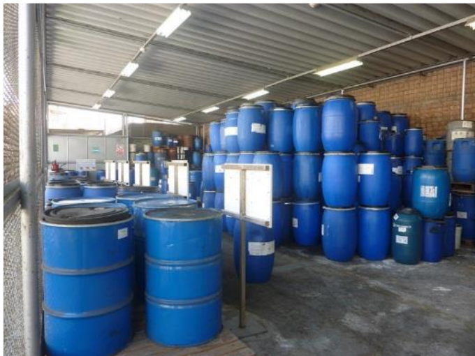
Ausencia de señaléticas de seguridad de riesgos de los productos
