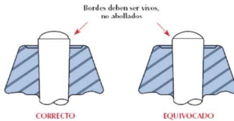
El diámetro de la punción debe coincidir con el diámetro de la base del remache a ser instalado.
