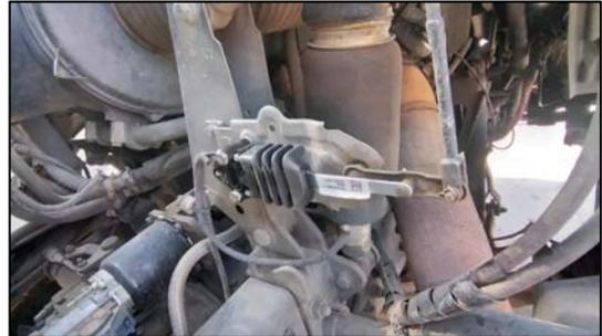
**FIGURA 54 FOTOGRAFÍAS: PUNTOS DE DIRECCIÓN ENSAMBLAJE COMPLETO**
