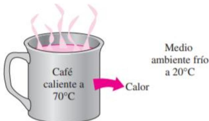
Figura 2: Transferencia de calor. Tomada por el libro de “Transferencia de calor y masa”, por (CENGEL, 2007 pág. 2)
