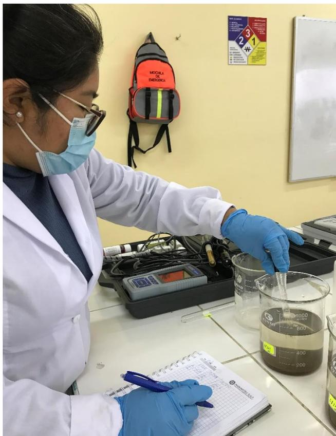
**Figura 25.** Medición de la conductividad
