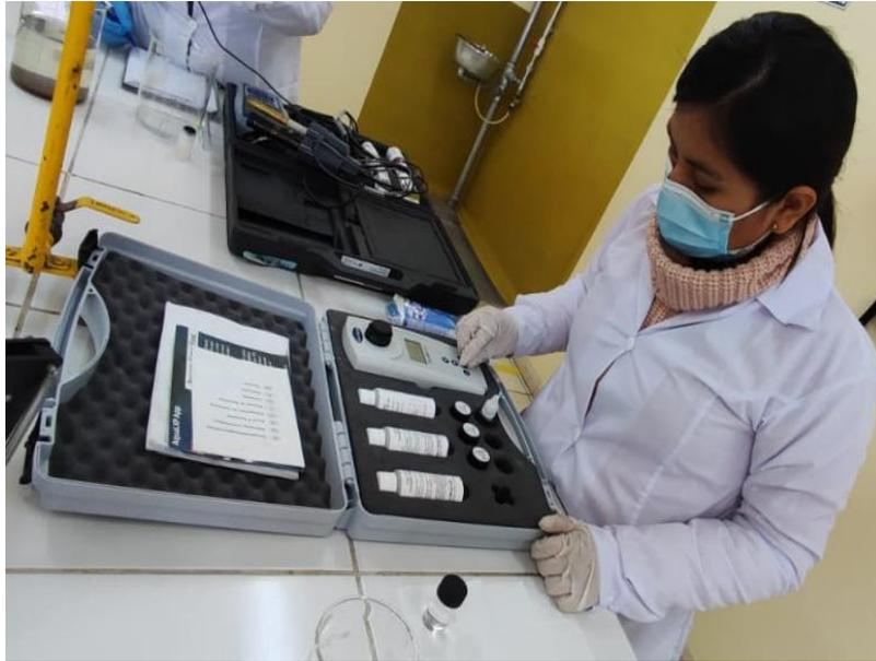
**Figura 27.** Medición de la DQO en el digestor
