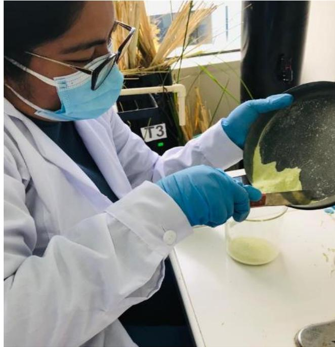
**Figura 21.** Obtención de pigmento del coagulante con filtro al vacío
