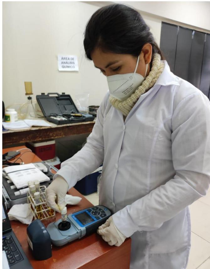
**Figura 28.** Medición de la DBO<sub>5</sub>
